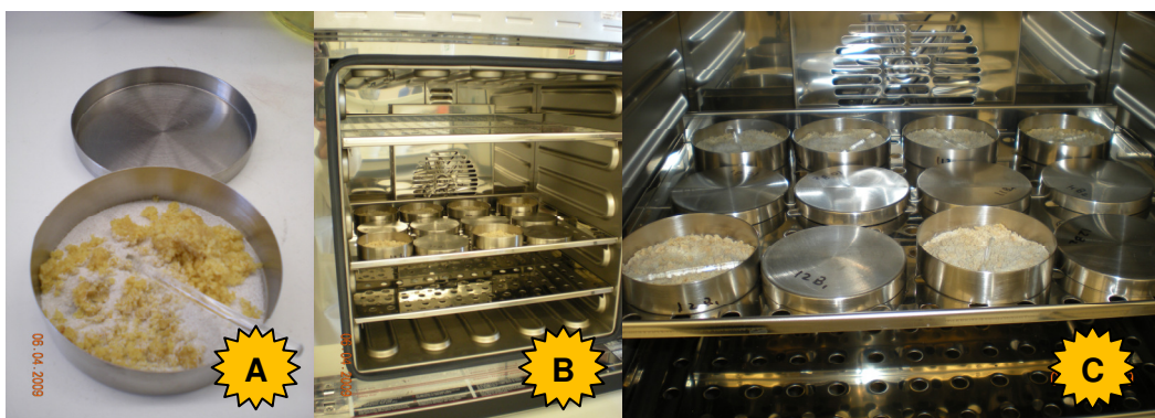
Figura 17. Principais etapas para a determinação do teor de humidade, pelo método de secagem em estufa. A – Homogeneização da amostra; B e C – Secagem em estufa.
