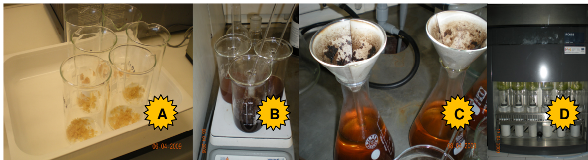
Figura 19. Principais etapas do método de hidrólise ácida com extracção. A – Amostras pesadas; B – Aquecimento com ácido clorídrico; C – Filtração; D – Extracção com o extractor de Soxhlet.
