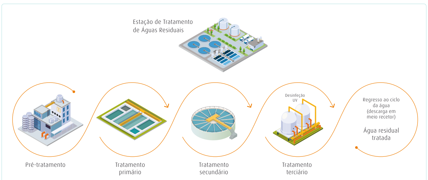
Figura 1: ⚡ Esquema representativo das várias fases de tratamento das águas residuais para a produção de água residual tratada (ART).
